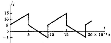
1-53 A un circuito paralelo  $RC$  se le aplica una tensión cuya forma de onda se representa en la Fig. 1-46. Hallar la corriente total  $i_T$ .
