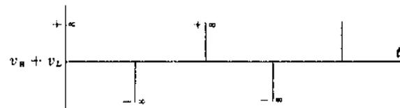
1-47 Por un circuito serie compuesto por una resistencia  $R = 5$  ohmios y una bobina de  $L = 0,004$  henrios circula una corriente cuya forma de onda de su intensidad es la representada en la Fig. 1-44. Obtener las gráficas de  $v_R$  y  $v_L$ .
