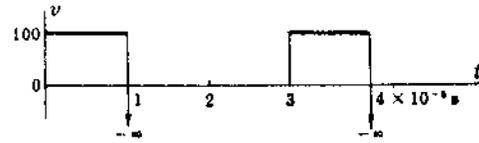
Nota. En la práctica, no es posible que la corriente que circula por una bobina sea una función discontinua, como ocurre con la forma de onda de esta corriente en los instantes  $t = 1$  ms y  $t = 4$  ms, ya que la tensión es la primera derivada de la intensidad respecto del tiempo y esta derivada tiene un valor negativo infinito en los puntos de discontinuidad, en los que la forma de onda de la tensión tendría unos valores negativos infinitos.
