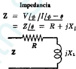
En la hipótesis de que la impedancia del circuito se reduzca a una resistencia en serie con una reactancia inductiva.
