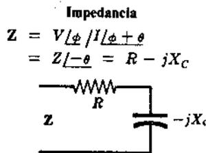
En la hipótesis de que la impedancia del circuito se reduzca a una resistencia en serie con una reactancia capacitiva.
