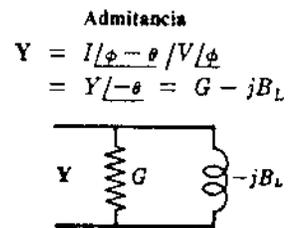
En la hipótesis de que la admitancia del circuito se reduzca a una conductancia en paralelo con una susceptancia inductiva.
