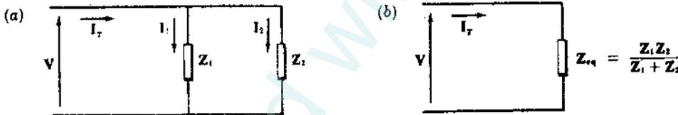
Fig. 6-7. Circuito paralelo de dos ramas
