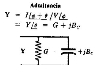
En la hipótesis de que la admitancia del circuito se reduzca a una conductancia en paralelo con una susceptancia capacitiva.
