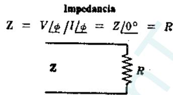
En la hipótesis de que la impedancia del circuito se reduzca a una resistencia pura  $R$  (ohmios).
